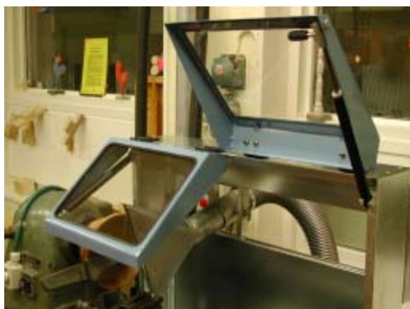
Utsugsmunstycket med teleskopfunktion i vertikalt läge för skålsvarvning, slipskiva mm...
