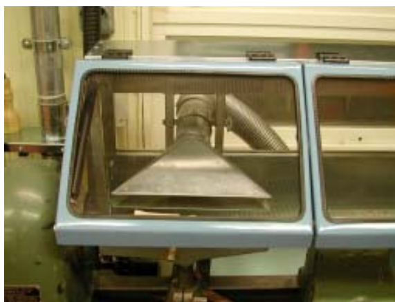
... ändras enkelt till horisontellt läge för längdsvarvning. Sugmunstycket kan även enkelt flyttas i sidled.
